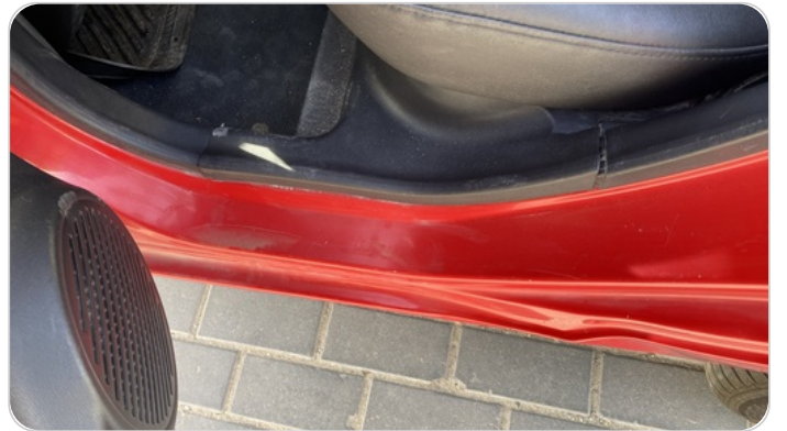
دواخل وقوائم باب الخلفي شمال : فبريكة (خرابيش)
